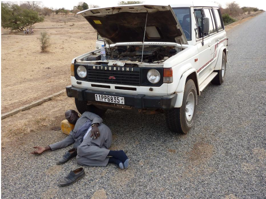
Mais non 50 km avant KENTCHARI à 15 h c'est la panne : tous les voyants s'allument la courroie du ventilateur vient de se rompre et pas de collant pour la remplacer !
